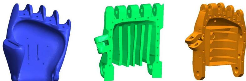
Figura 1. Palma da mão, comparação de três modelos para análise de resistência mecânica.
